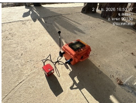
รูป 43 ตรวจวัดแรงสั่นสะเทือน และแรงอัดอากาศจากการระเบิด
