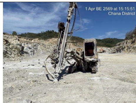
รูป 32 การเจาะรูระเบิดจะต้องติดตั้งเครื่องมือตัดฝุ่นที่ บริเวณหัวเจาะ
